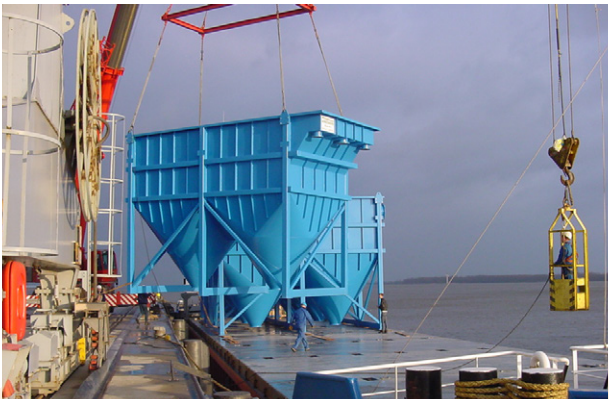
Koagulation - hydraulische Flockung - Lamellenseparation von Oberflächenwasser für die Prozesswasseraufbereitung (Elbe, Deutschland, Zulaufmenge: 1.200 m 3 / h)
