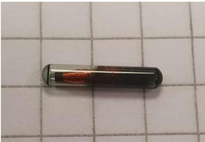
Abbildung 2 – RFID Chip - Länge 11,5 mm und Durchmesser 2,12 mm
